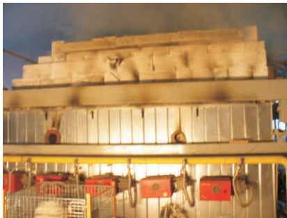
Zdjęcie komory ogniowej przeznaczonej do testów wg DIN 4102-12
